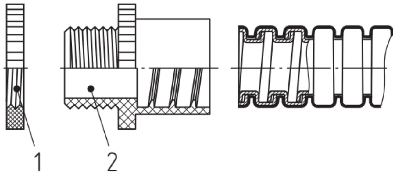
1 – Гайка прижимная, 2 – Корпус
